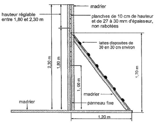
Largeur de la palissade comprise entre 1,50 et 1,90 m
